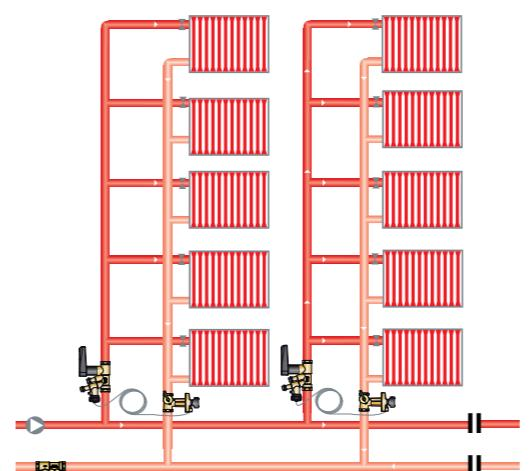
Не смотря на то, что в таких системах само по себе сложно обеспечить точное распределение расхода между контурами отопления, применение клапана Ballorex® DP совместно с клапаном Venturi значительно улучшит ее рабочие характеристики.
