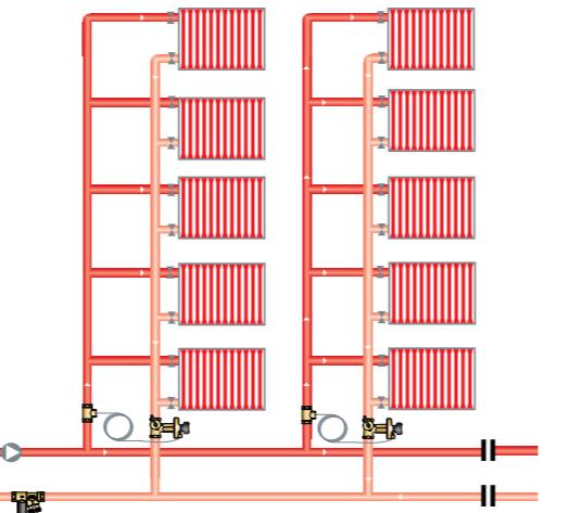
температуры в помещении. При совместной установке с клапаном Ballorex® Venturi в качестве клапана партнера устанавливаемого на подающей трубе расход ограничивается при помощи клапана Venturi.
