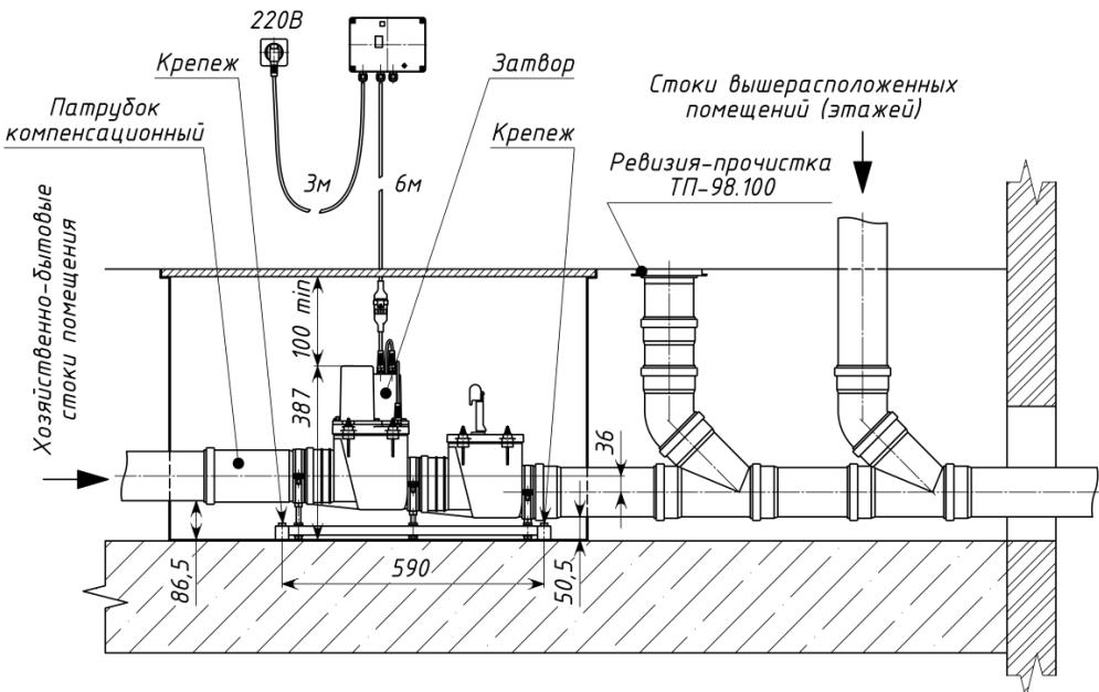
Рис. 4. Монтажная схема
